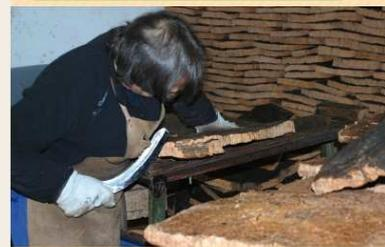
Lo primero que se hace es un **rebaneo**, en el que se cortan las planchas en tiras llamadas **rebanadas**, que pasarán a una máquina perforadora la cual, mediante una gubia (cuchilla en forma de tubo), va perforando y empujando los tapones fuera de la rebanada.
