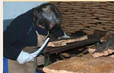
Lo primero que se hace es un **rebaneo**, en el que se cortan las planchas en tiras llamadas rebanadas, que pasarán a una máquina perforadora la cual, mediante una gubla (cuchilla en forma de tubo), va perforando y empujando los tapones fuera de la rebanada.
