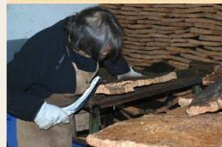
Lo primero que se hace es un **rebaneo**, en el que se cortan las planchas en tiras llamadas **rebanaadas**, que pasarán a una máquina perforadora la cual, mediante una gubia (cuchilla en forma de tubo), va perforando y empujando los tapones fuera de la rebanaada.
