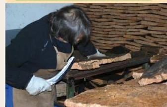
Lo primero que se hace es un **rebano**, en el que se cortan las planchas en tiras llamadas rebanadas, que pasarán a una máquina perforadora la cual, mediante una gubia (cuchilla en forma de tubo), va perforando y empujando los tapones fuera de la rebanada.
